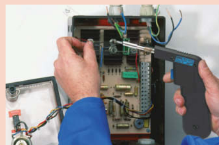
Anwendung Lötspistole ERSA Multi-Sprint
